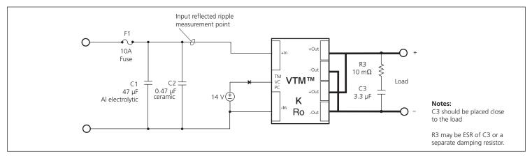
**Figure 15** — VTM<sup>™</sup> module test circuit
